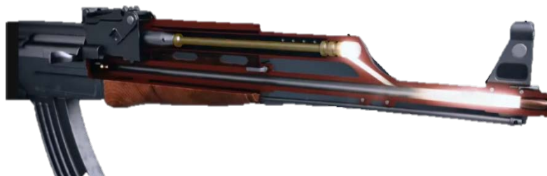
63-rasm. Turtkich pistonini chaqishi va porox zaryadning yonishi
