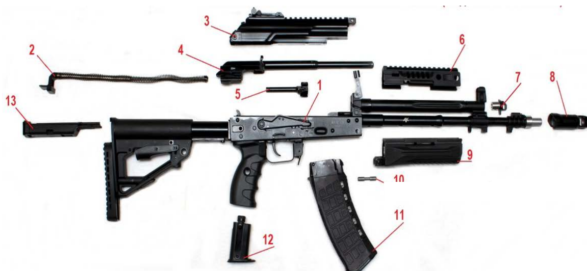
35- rasm. Avtomatining asosiy qism va mexanizmlari
