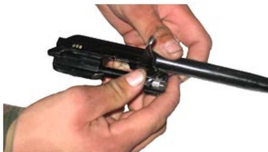
74-rasm. Zatvorni zatvor ramasidan ajratish
