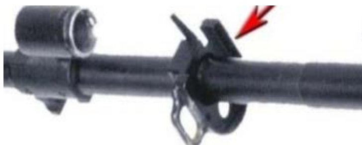
82-rasm. Biriktiruvchi muftani siljitish
