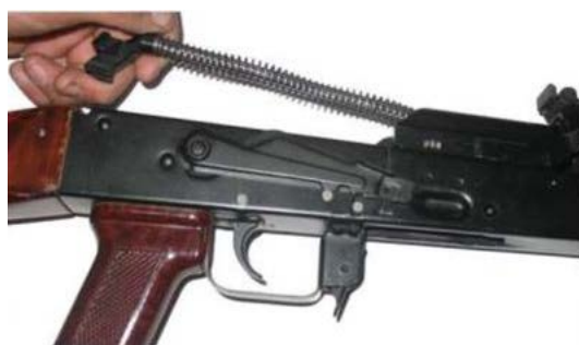
72-rasm. Qaytaruvchi mexanizmni ajratish
