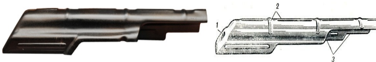
49-rasm. Stvol qutisi qopqog‘i: 1-zinasimon kesmalar; 2- tuynuk; 3- qovurg‘alar.
