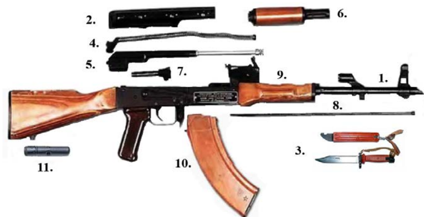
7-rasm. 1) Stvol, stvol qutisi, mo'ljalga olish moslamasi, zarbdor-tepki mexanizmi, pistolet dastagi va qo'ndog' bilan birgalikda; 2) Stvol qutisi qopqog'i; 3) Nayza-pichoq; 4) Qaytaruvchi mexanizm; 5) Zatvor ramasi gaz porsheni bilan; 6) Gaz trubkasi stvol qoplamasi bilan; 7) Zatvor; 8) Shompol; 9) Stvolosti qoplamasi; 10) O'qdon; 11) Penal anjomlari
