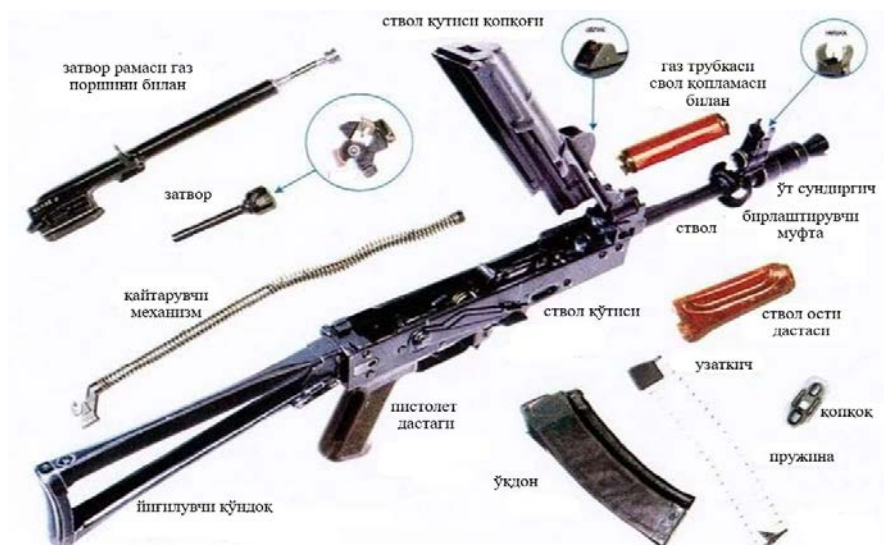
24-rasm. AKS-74U avtomatining asosiy qism va mexanizmlari
