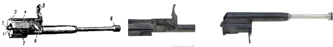
51-rasm. Zatvor ramasi gaz porsheni bilan birgalikda: 1-zatvor uchun kanal; 2- saqlovchi bo'rtiq; 3- avtotepki richagini bo'shatish uchun bo'rtiq;4- stvol qutisi devoridagi bukilmaga joylashish uchun kesma; 5- dasta; 6- egri kesma; 7-to'suvchi bo'rtiq uchun kesma; 8- gaz porsheni
