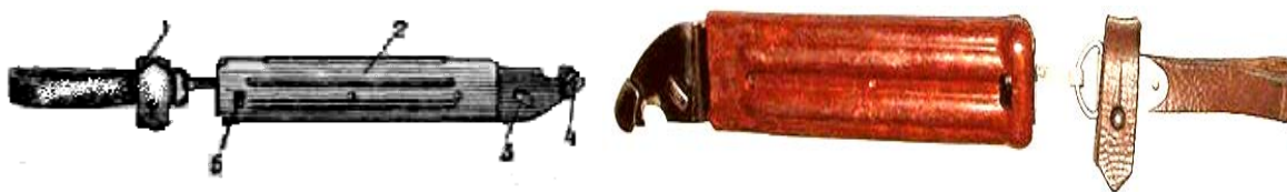
59-rasm. Qin: 1- ilgich, sirtmoqli kamar va karabin bilan birgalikda; 2- plastmassali g‘ilof; 3- o‘q-bo‘rtiq; 4- tayanch; 5- yassi prujina biriktirgichi.
