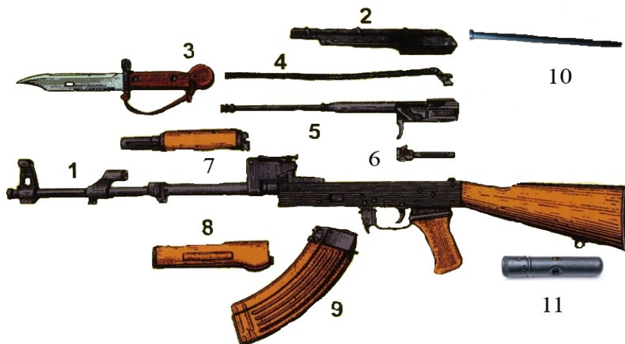
4-rasm. Asosiy qism va mexanizmlar: 1) stvol, stvol qutisi, mo'ljalga olish moslamasi, zarbdor-tepki mexanizmi, pistolet dastagi, qo'ndoq bilan birgalikda; 2) stvol qutisi qopqog'i; 3) nayza pichoq; 4) qaytaruvchi mexanizm; 5) zatvor ramasi, gaz porsheni bilan; 6) zatvor; 7) gaz trubkasi stvol qoplamasi bilan; 8) stvolosti qoplamasi; 9) o'qdon; 10) shompol; 11) Penal.
