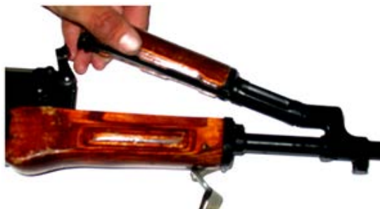
74-rasm. Gaz trubkasini stvol qoplamasi bilan birgalikda ajratish
