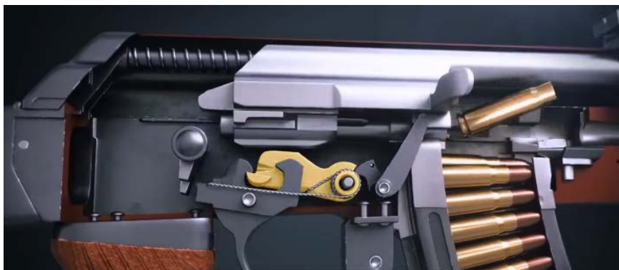
65-rasm. Zatvor ramasi zatvor bilan birga gilzani tashqariga uloqtirish tartibi.
