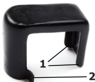
44-rasm. Uzatgich (metaldan): 1 – bukilgan uchlari; 2 – zatvor tutqichi uchun tishcha.
