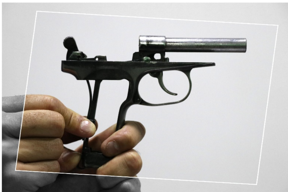
26-rasm. Jangovar prujinani surma qisqich bilan qotirish.
