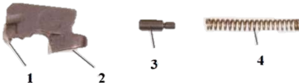
31-rasm. Uloqtirgich: 1 – zasep (ilgak); 2 – zatvor bilan birlashtirish uchun tovoncha; 3 – gnetok; 4 – uloqtirgich prujinasi.
