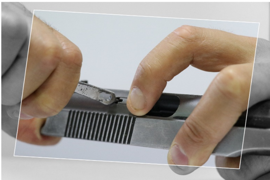
18-rasm. Zatvordan uloqtirgichni ajratish.
