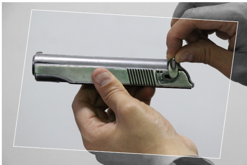
22-rasm. Saqlagichni zatvorga o‘rnatish.
