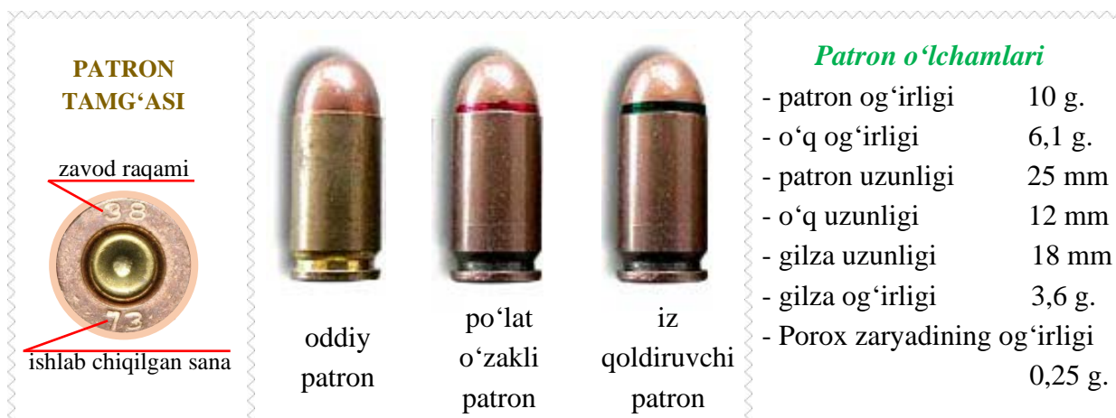
1-rasm. Patronning tuzilishi.
