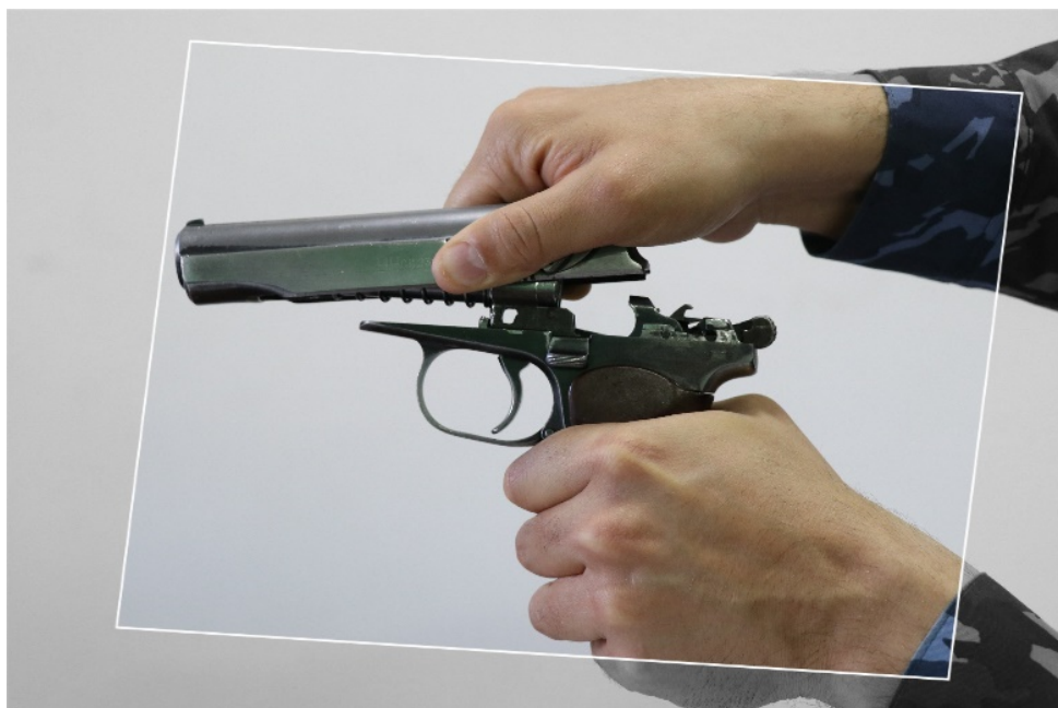
8-rasm. Qaytaruvchi prujinaning bo'sh uchini zatvor kanaliga kiritish.
