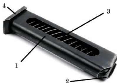
57-расм. Саккиз зарядли магазин: 1 – магазин корпуси; 2 – узатгич; 3 – узатгич пружинаси; 4 – магазин қопқоғи
