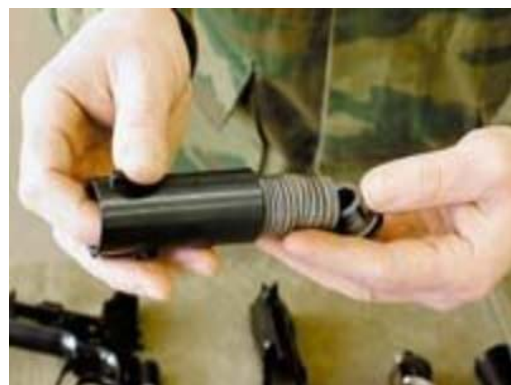
103-расм. Газ камерасини пистолетдан ажратиш.
