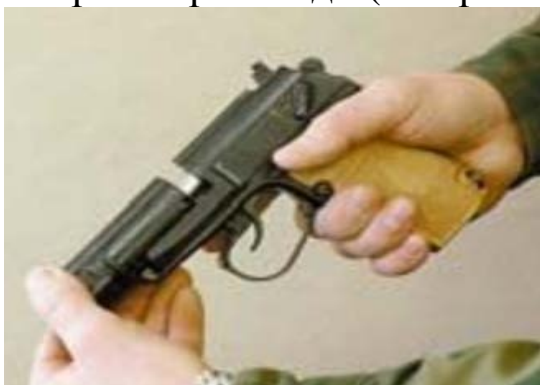
103-расм. Газ камерасини пистолетдан ажратиш.
