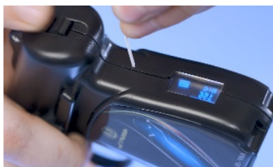
217-расм. АИР «М-140» русумли электрошок қурилмаси менюсига кириш.
