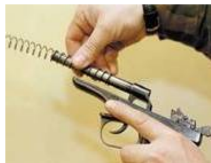
79-расм. Стволга қайтарувчи пружина кийдириш.
