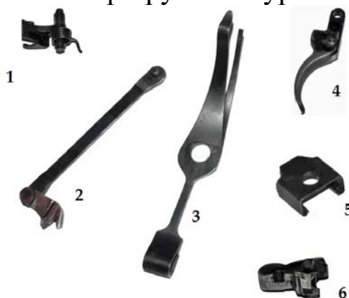
49-расм. Зарбдор тепки механизми: 1 – пружинали шептало; 2 — взвод ричагили тепки тягаси взвод дастаги билан; 3 – жанговар пружина; 4 – тепки ҳалқаси;
