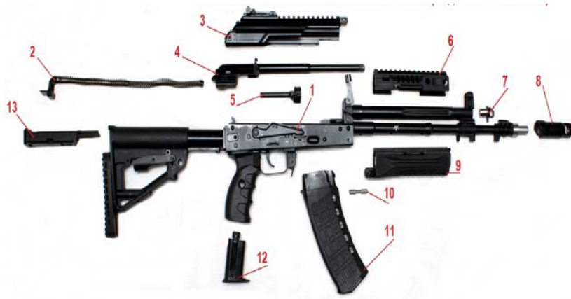
123-расм. Автоматининг асосий қисм ва механизмлари.
