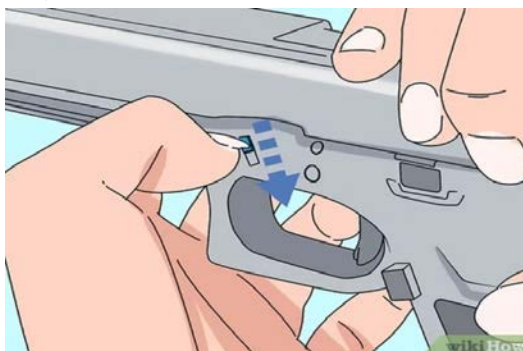
116-расм. Затвор блокировкасини пастга тушириш.
