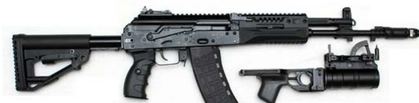
122 - расм. АК-12 автоматининг ГП-25 ва ГП-34 ствол ости гранатомёти билан биргаликдаги кўриниши.
