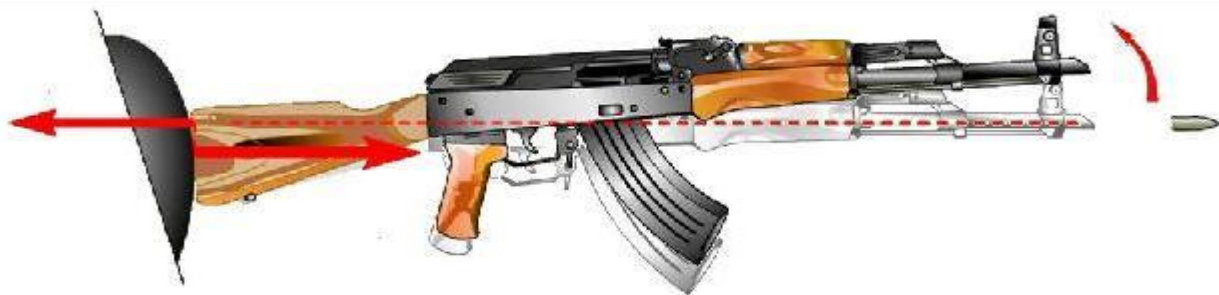
2-расм. Ўқ отиш пайтида қурол тегиши натижасида қурол оғзининг юқорига силтаниши
