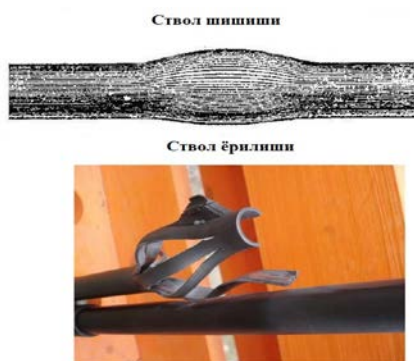
3-расм. Стволнинг шишиши ва ёрилиши
