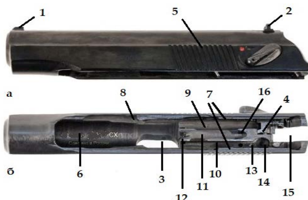
44-расм. Пистолет затвори: а – чап томони; б – пастдан кўриниши: 1 – мушка; 2 – целик; 3 – гильза (патрон) улоқтиргичи учун дарча; 4 – сақлагич уяси; 5 – керттик; 6 – стволни қайтариш пружинаси билан бирга жойлаштириш учун канал; 7 – затворни рамка бўйлаб ҳаракатлантириш йўналиши учун бўйлама бўртиқлар; 8 – затворни затвор ушлагичига қўйиш учун тиш; 9 – қайтариш учун паз; 10 – взвод ричагининг ажратувчи бўртиги учун паз; 11 – шепталони взвод ричагидан ажратиш учун чуқурча; 12 – олиб
