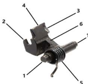
51-расм. Шептало: 1 – шептало цапфалари; 2 – тиш; 3 – бўртиқ; 4 – шептало бурунчаси; 5 – шептало пружинаси; 6 – шептало стойкаси.
