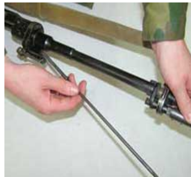
157-расм. Газ поршени ва турткич пружина билан биргаликда ажратиши.
