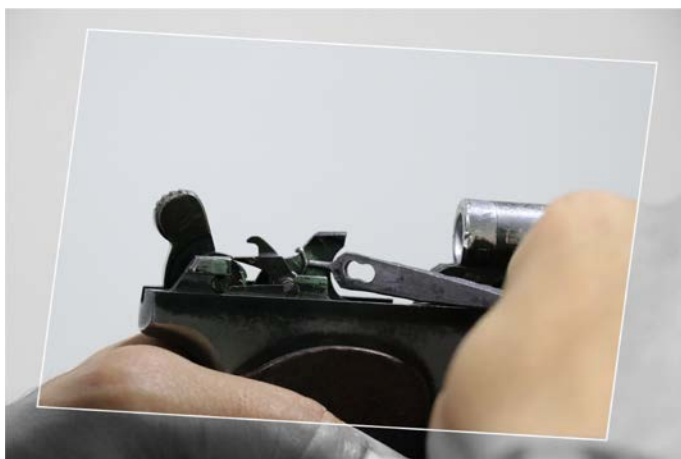
26-расм. Шептало пружинасининг илгагини затвор ушлагичидан тушириши.
