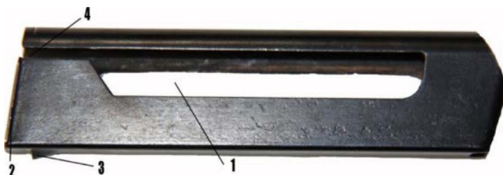
58-расм. Магазин корпуси: 1 – дарча; 2 – эгилган қовурга; 3 – бўртиқ; 4 – қирқим; 5 – букик жой.
