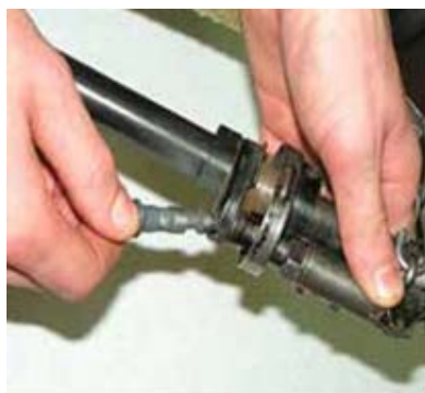
157-расм. Газ поршени ва турткич пружина билан биргаликда ажратиши.
