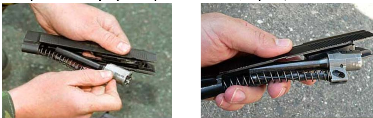
89-расм. Ствол, шток ва қайтарувчи пружинани затвор асосидан ажратиш.
