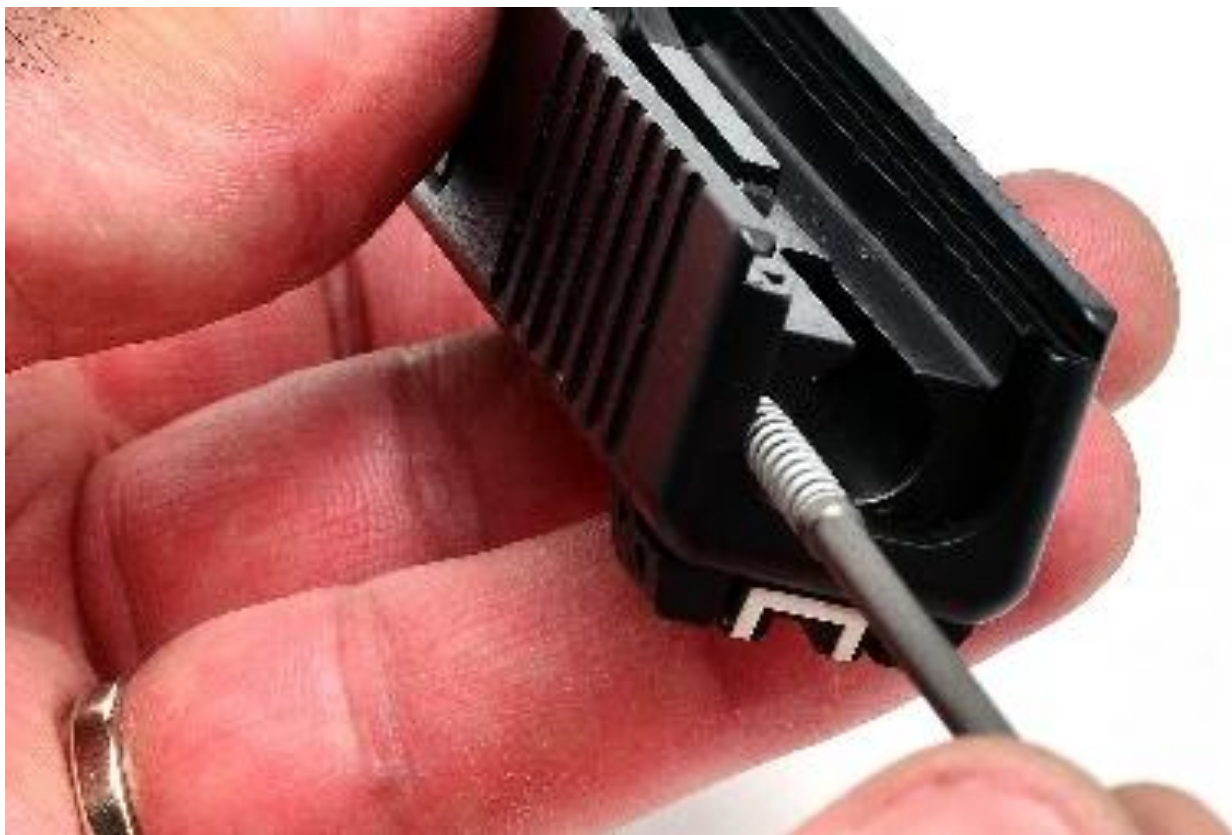
25-rasm. Uloqtiruvchini itaruvchi mexanizmning ajratilishi.
