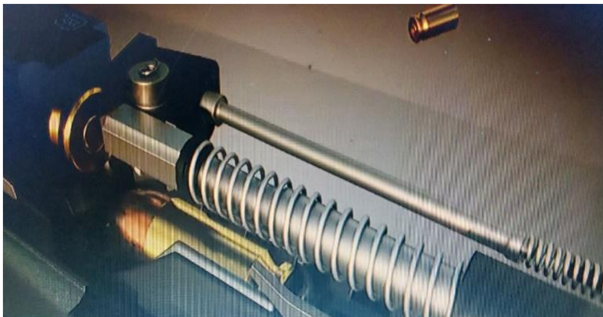
46-rasm. Zatvorning orqaga tortilishi va patronning patrondonga joylashuvi.
