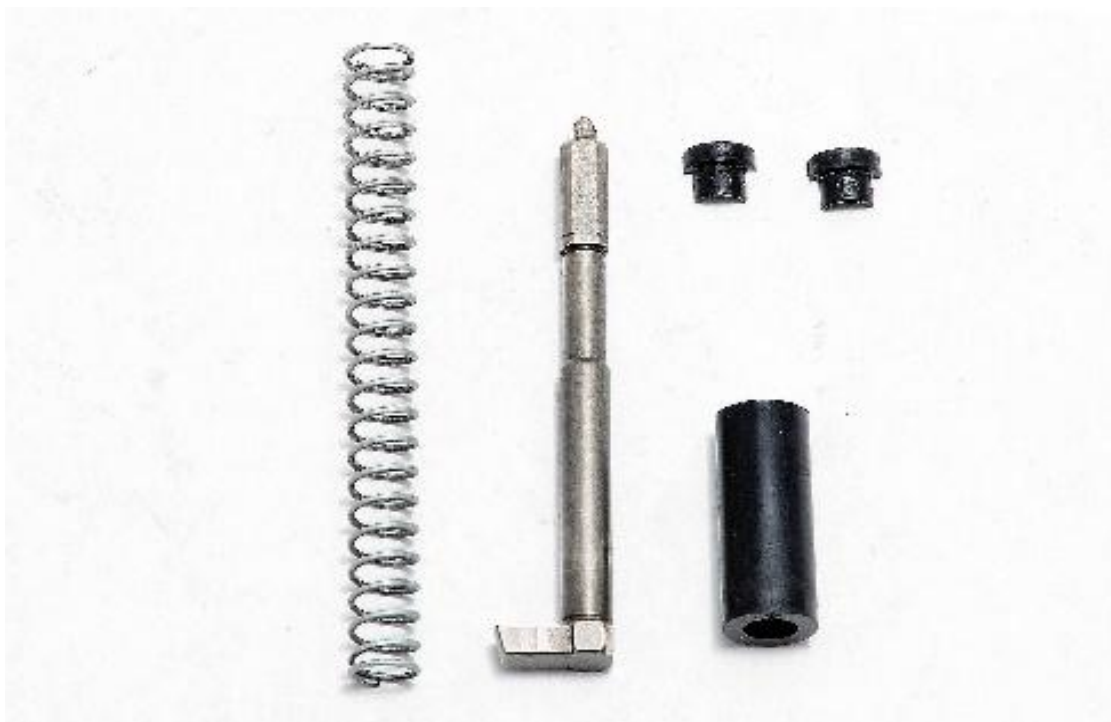
24-rasm. Qismlarga ajratilgan jangovar prujina.
