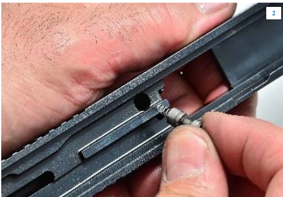
27 rasm. Uloqtirgich bilan turtkich saqlagichining ajratilishi.
