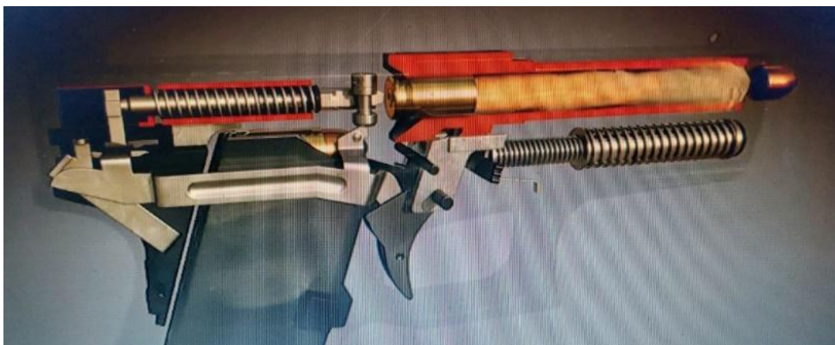
52-rasm. Turtkichning alanganuvchi kapsyulaga zarba berishi, porox zarayadining kengayuvchi gazlari o'qni stvol kanalidan kuchli bosim bilan itarib chiqarishi.
