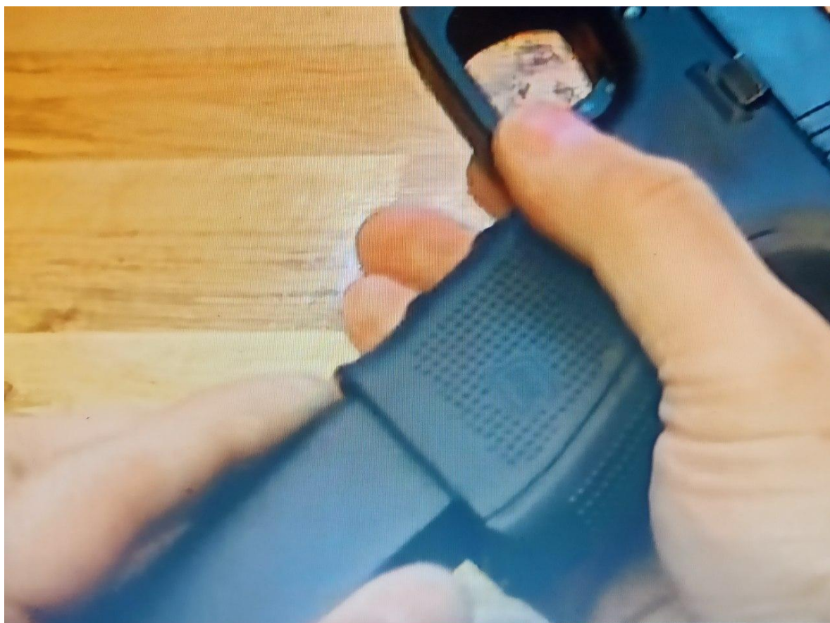
45-rasm. O'qdonning qo'l dastagiga o'rnatilishi.
