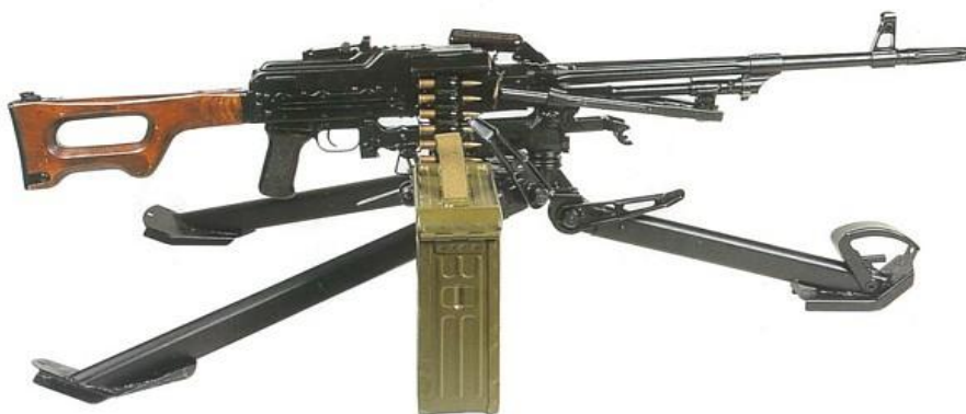
199-расм. Саможенков станокига ўрнатилган Калашников пулемёти ПКС 250-патрон сизимли қутиси билан биргаликда
