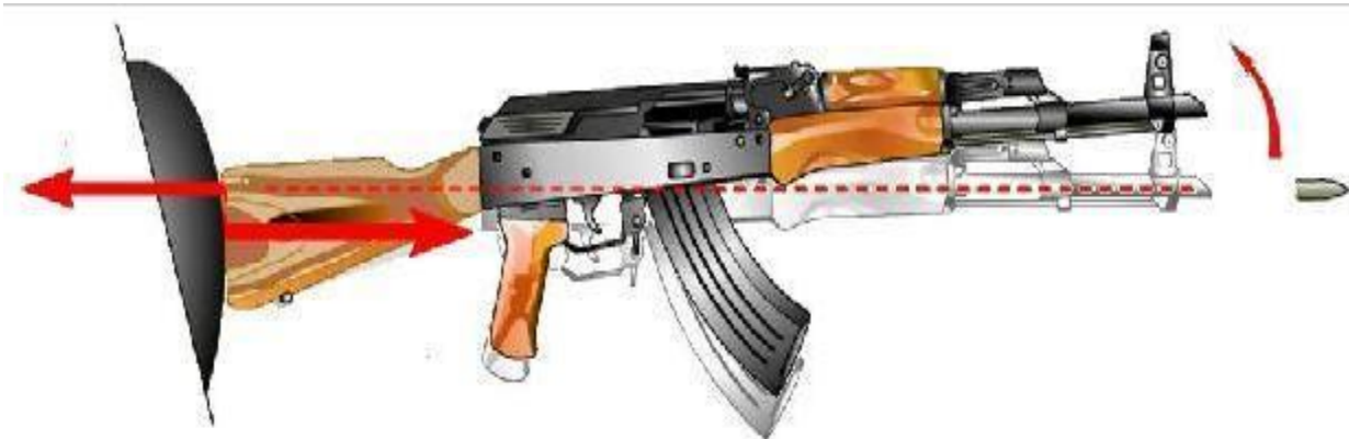
4-расм. Қуролдан ўқ отилган вақтда қуролнинг орқага тисланиши
