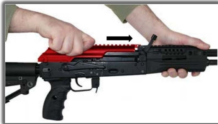
70-rasm. Qopqoqni biriktirish
