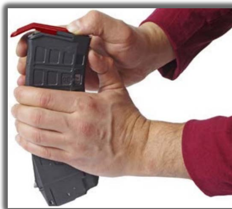
80-rasm. O'qdon qopqog'ini ajratish
