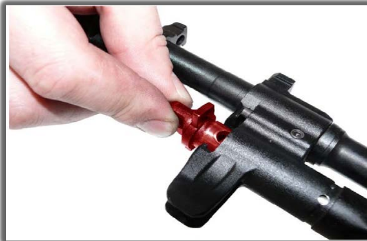
67-rasm. Tiqin (заглушка)ni gaz kamerasiga o'rnatilishidagi holati.
