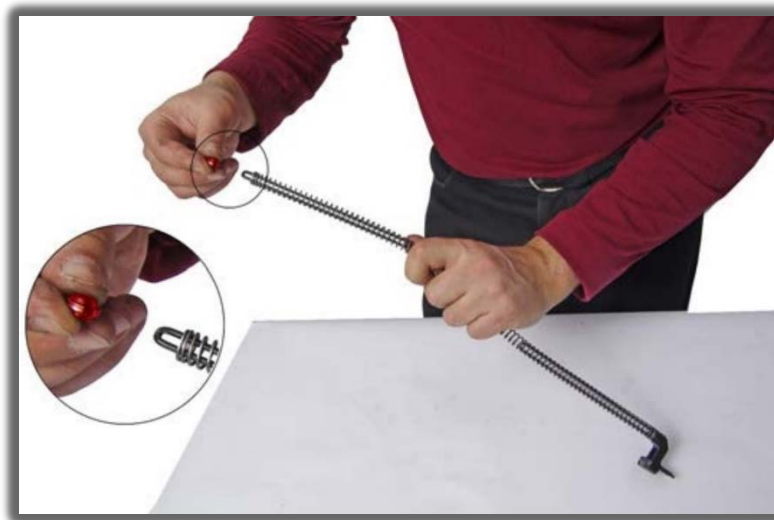
81-rasm. Qaytaruvchi mexanizm muftasini ajratish
