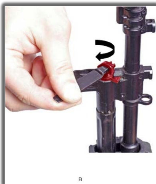
66-rasm. Tiqin (заглушка)ni ajratish
