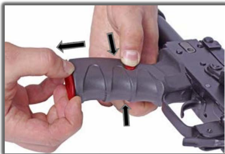
60-rasm. Dastakdan penalni chiqarish
