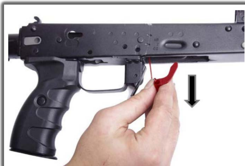
89-rasm. Stvol qutisidan avtospuskni prujina bilan birgalikda ajratib olish
