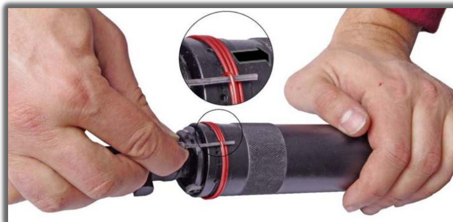
40-rasm. PMSni to'g'rilashda to'xtatuvchi halqa bukilmasining holatini o'zgartirish.
