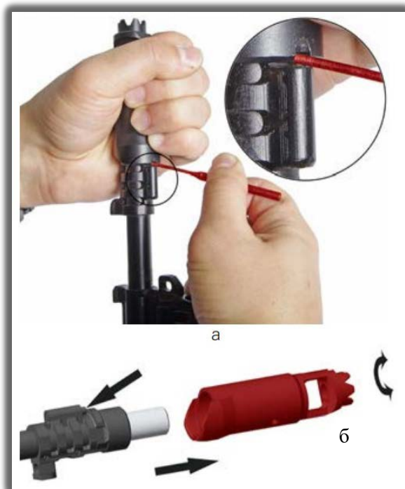
61-rasm. DT (дульный тормоз (og'iz tormozi))ni ajratish.
