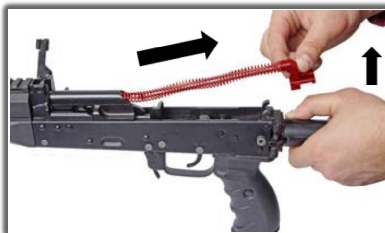
63-rasm. Qaytaruvchi mexanizmni ajratish
