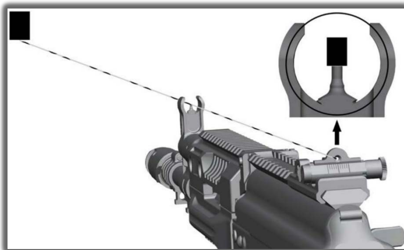
31-rasm. Dioptrik moʻljallagichdan foydalangan holda moʻljalga olish
