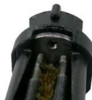
76-rasm. Shompol uchun rezbalı teshiklarning joylashuvi
