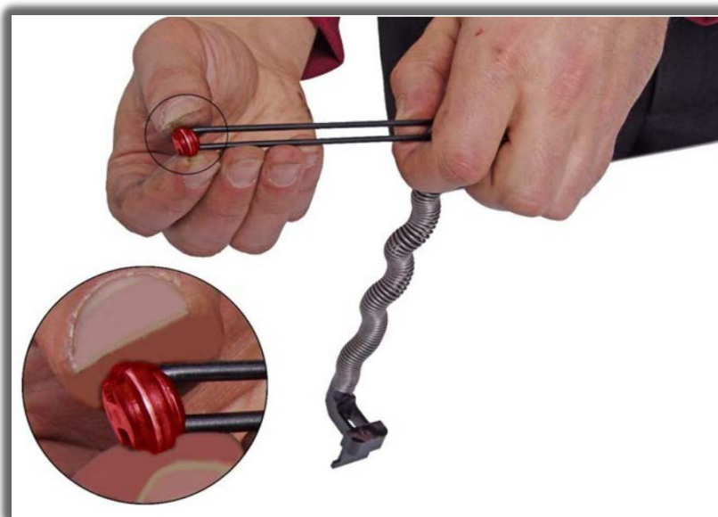
102-rasm. Qaytaruvchi mexanizmni yig'ish
