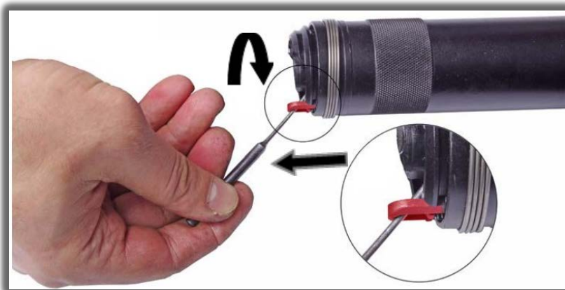
38-rasm. Fiksatorni kiritgich (выколотка) bilan bosib, PMSni to'g'ri keltirish
