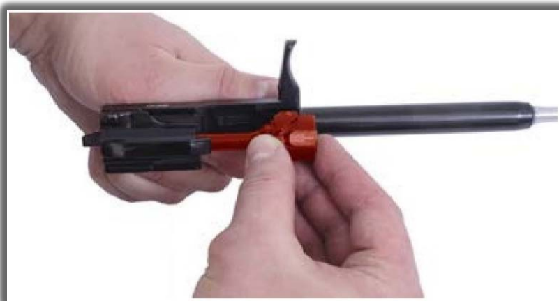
68-rasm. Zatvor ramasi zatvorni kiritishda zatvorni uning ramasi nisbatan holati
