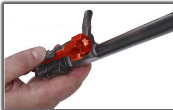
69-rasm. Zatvor ramasini zatvor bilan stvol qutisiga biriktirilishidagi zatvorning uning ramasiga nisbatan holati
