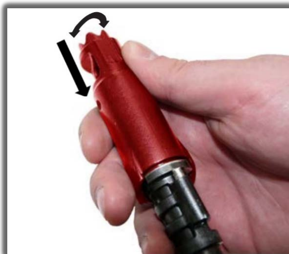
71-rasm. DT (дульный тормоз (og'iz tormoz))ni biriktirish.
